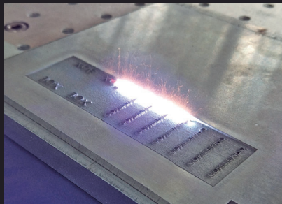
※50Wのファイバーレーザーでアルミ板を彫刻
