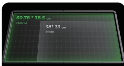
xTool S1 は、607.8mm x 385mm のベッドサイズと 498mm x 319 mm 作業エリアを有しています。
