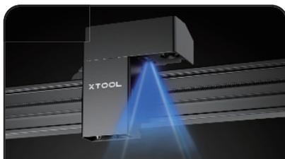
焦点距離の測定は LiDAR 測距システムによるオートフォーカスを採用し、その測定精度はわずか 0.001 インチと高精度です。
