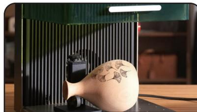
xTool独自の3D Curve™機能により、3Dスキャンヘッドを搭載したビジネスモデルに匹敵する曲面への加工を実現。
